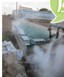
産 蒸気消毒槽 温泉蒸気で土壌・資材を消毒(大分県農林水産研究指導センター花きグループ)
